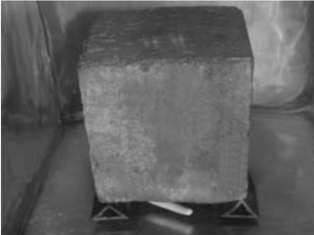
Bild VI-2: Auslaugung eines Betonwürfels (Abmessungen 10 x 10 x 10 cm 3 ) in einem Langzeitstandtest
