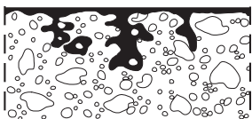
e) Auftragen von Versiegelungen (teilweise filmbildend), „Imprägnierung“
