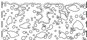
d) Auftragen von hydrophobierenden Imprägnierungen, „Hydrophobierung“
